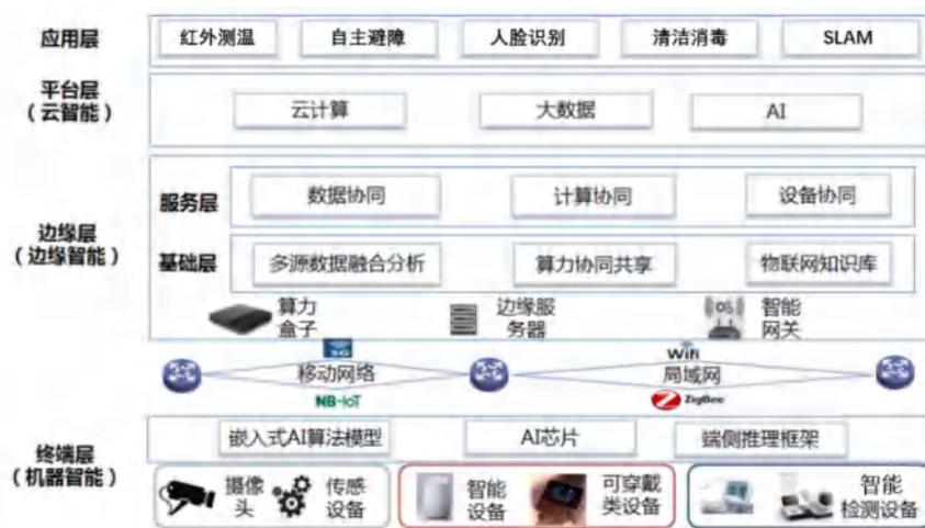
图 13.端-边-云协同的智能系统架构<sup>[8]</sup>
