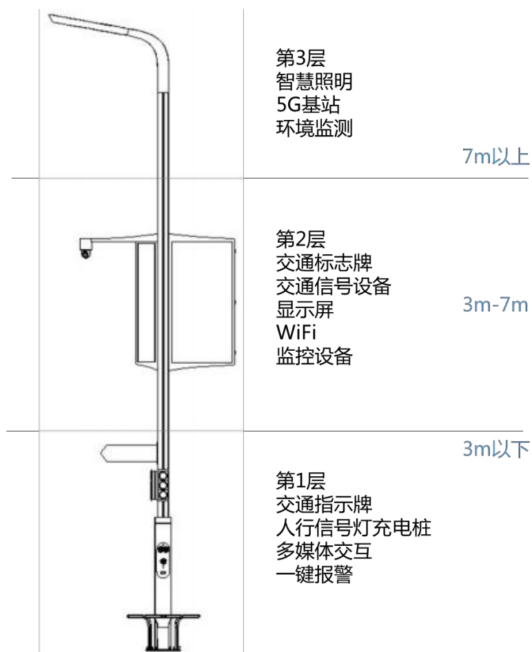
图 1 多功能信息杆柱杆塔三层设计示意图
