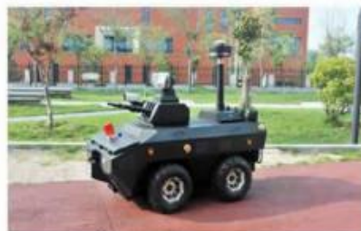
安防巡检机器人
