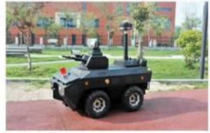
安防巡检机器人
