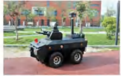
安防巡检机器人
