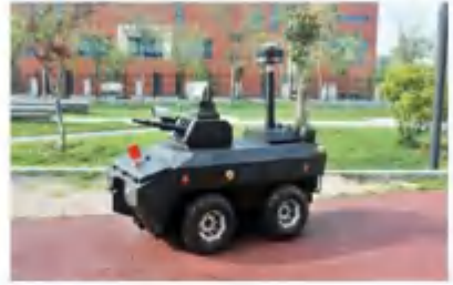
安防巡检机器人
