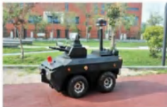
安防巡检机器人
