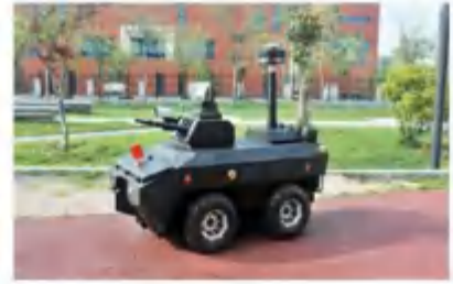
安防巡检机器人
