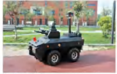
安防巡检机器人
