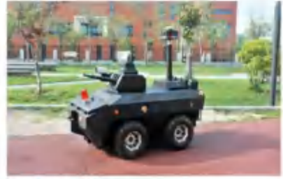
安防巡检机器人
