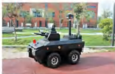
安防巡检机器人
