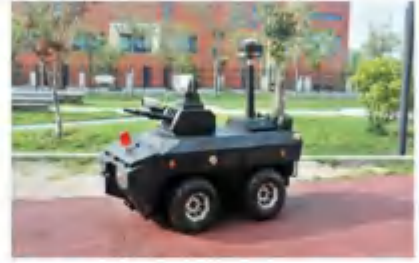
安防巡检机器人
