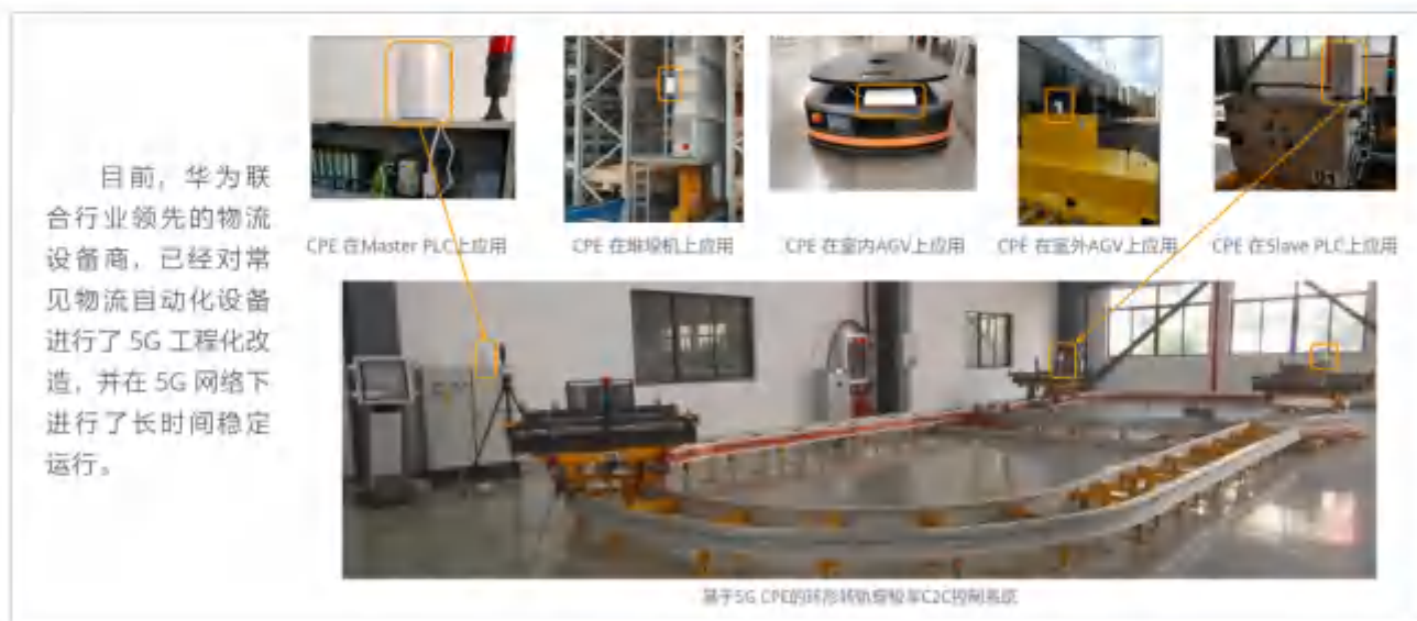
图 40: CPE 在物流自动化设备上的应用
