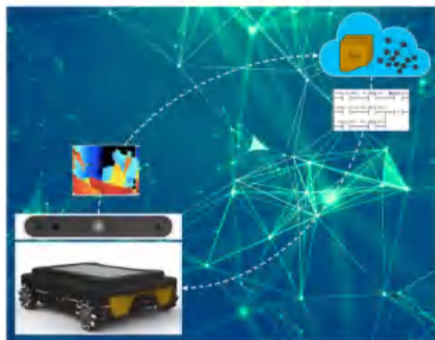
图 18: 云化 VSLAM 系统示意图
