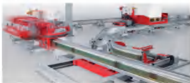
图 16: 地面电动单轨系统示意图 [17]
