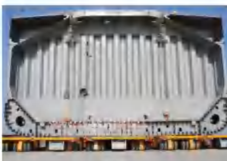
图 12: 多 AGV 协同搬运示意图
