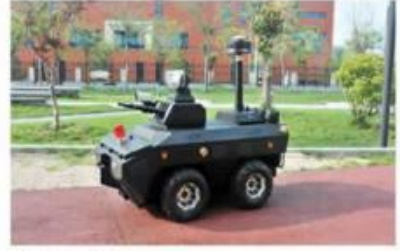
安防巡检机器人
