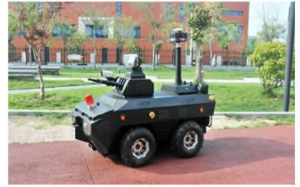
安防巡检机器人
